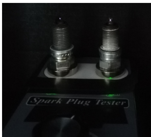
links NGK DCPR 7EIX (Iridium) rechts NGK DCPR 7E bei ca. 4000U/min
