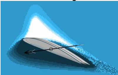
Idealisierte, überzeichnete Darstellung der Druckverteilung beim Auftriebskollaps (stall)
